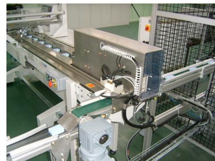
Vue du module de regroupage et d'alimentation en savonnettes de la machine
