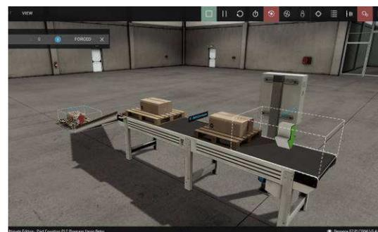
**AUTOMATICC-Factory est un outil de programmation qui permet un apprentissage ludique et progressif des automatismes industriels. L'Automate Programmable Industriel API avec son Interface Homme Machine IHM pilotent les systèmes industriels virtuels du logiciel de simulation 3D Factory I/O. Cet ensemble est universel : il peut être proposé avec différentes gammes d'API.**
